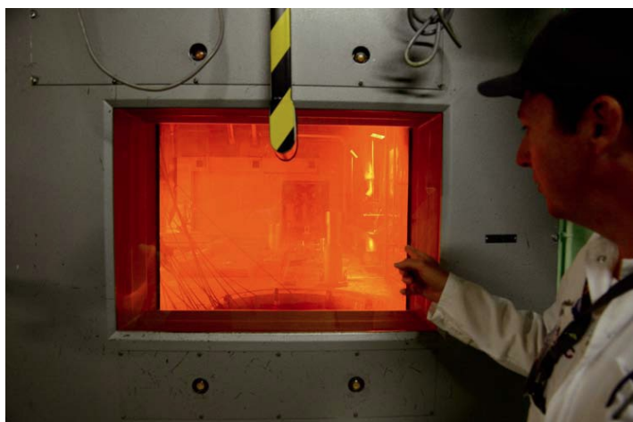
Dans l'atelier T0 de l'usine nucléaire de La Hague, où le combustible irradié est déchargé à sec, seuls des robots peuvent travailler.
